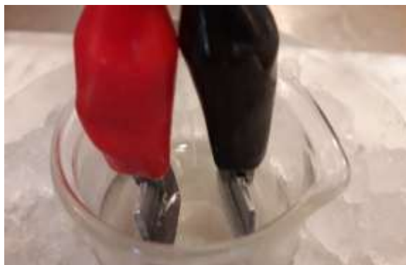
Figura 21. Baño de hielo con Ácido Sulfúrico (15%) y láminas de aluminio
